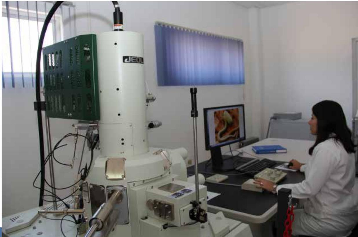
Microscopio Electrónico de Barrido de misión de campo y de alta resolución (FE-SEM) JSM-7100F. Tecnología de punta, nos ubicamos dentro de un grupo selecto de instituciones que cuentan con tecnología sofisticada para realizar investigación de alto nivel en el país.
